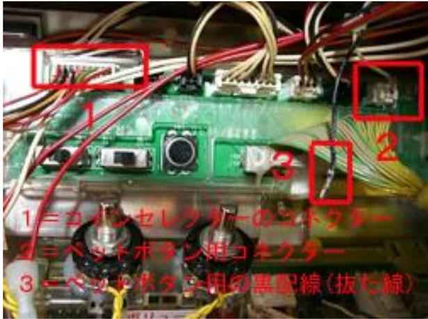
コイン不要機を取り付ける作業は、**必ず台の電源はOFF**
