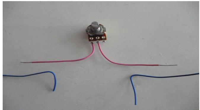
選択した配線を、加工しやすい部分で切断します。
